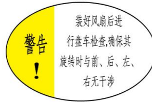
风扇安装警示标识牌
