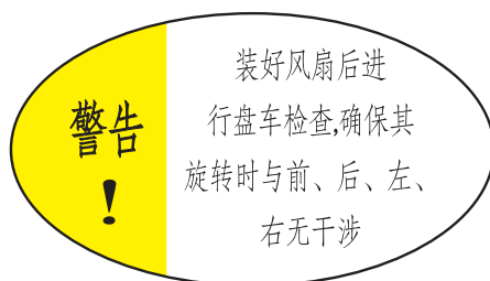
风扇安装警示标识牌
